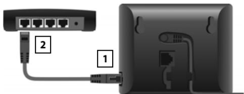
Sobald das Kabel zwischen Telefon und Router gesteckt und der Router eingeschaltet ist, leuchtet die Taste auf der Vorderseite der Basis (Paging-Taste).
