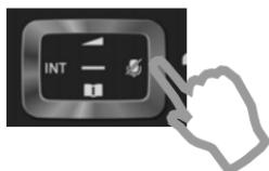
Wollen Sie die Eingabeposition ändern, um z. B. eine Eingabe zu korrigieren, drücken Sie **rechts** oder **links** auf die Steuer-Taste.
